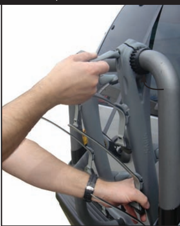
10. Elevar la palanca de leva en el brazo.
