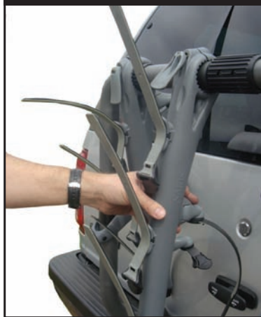
11. Deslizar los brazos hasta la posición central.
